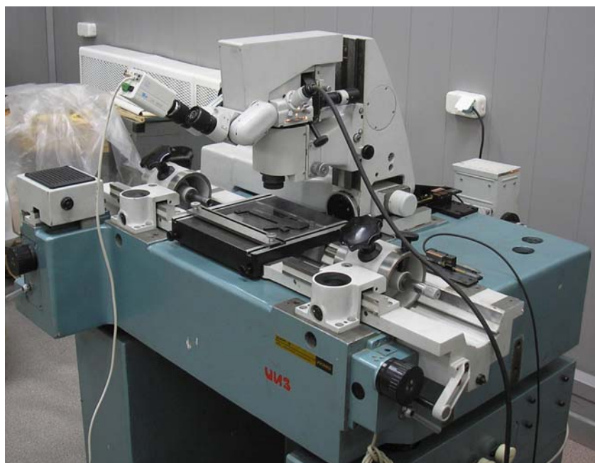
Рисунок 5 – Пример модернизации микроскопа ДИП 3
