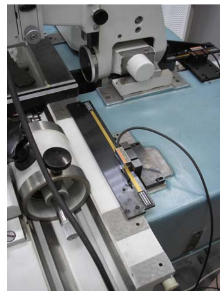
Рисунок 5 – Пример модернизации микроскопа ДИП 3
