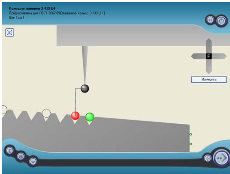
Рисунок 3 – Пример экранной формы для проведения измерения калибра - кольца
