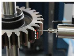
**Назначение:** измерительная система предназначена для измерения линейно-угловых параметров высокоточных деталей и инструментов с диапазоном контролируемых диаметров от 40 до 280 мм (по заказу до 630 мм).
