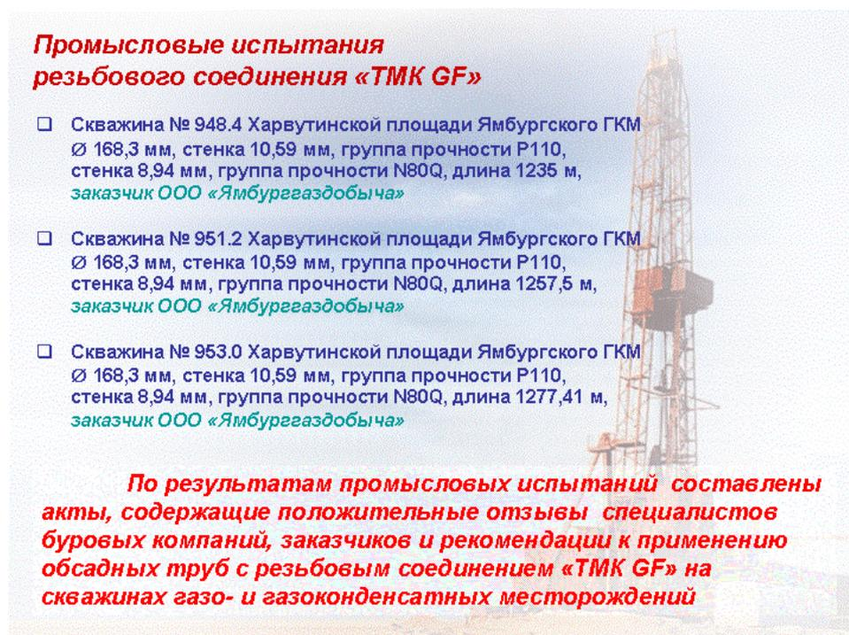
В настоящее время завершились промышленные испытания партии обсадных труб с резьбовым соединением «ТМК GF» на газовых месторождениях полуостров Ямал (рис. 51). По результатам промышленных испытаний составлены акты, содержащие положительные отзывы специалистов буровых компаний, заказчиков и рекомендации к применению обсадных труб с резьбовым соединением «ТМК GF» на скважинах газо- и газоконденсатных месторождений.
